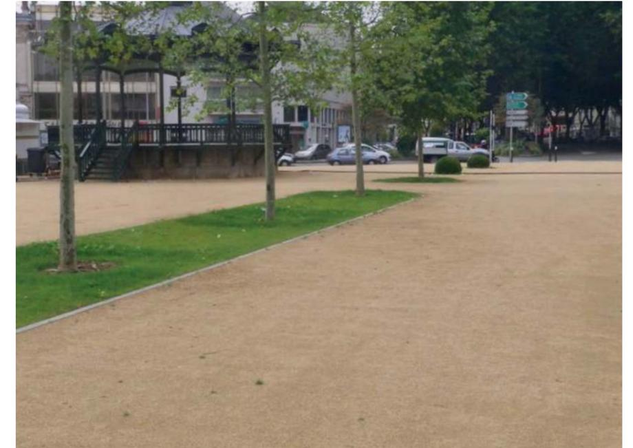
Sol en sable stabilisé renforcé avec le liant naturel - Ratio surface minérale 100%
